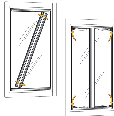
13. Inserire il pacco tessuto all'interno delle guide e accostare i tendifilo alle rispettive sedi
